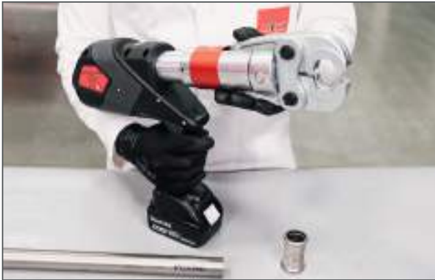
Preparazione della macchina pressatrice / Press machine preparation
